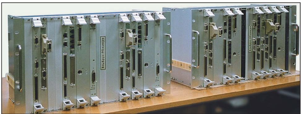
Два двухплатных вычислительных комплекса «Эльбрус-90микро» в конструктиве «Евромеханика», стандарт cPCI, встраиваемое исполнение. Фото ЗАО «МЦСТ»
